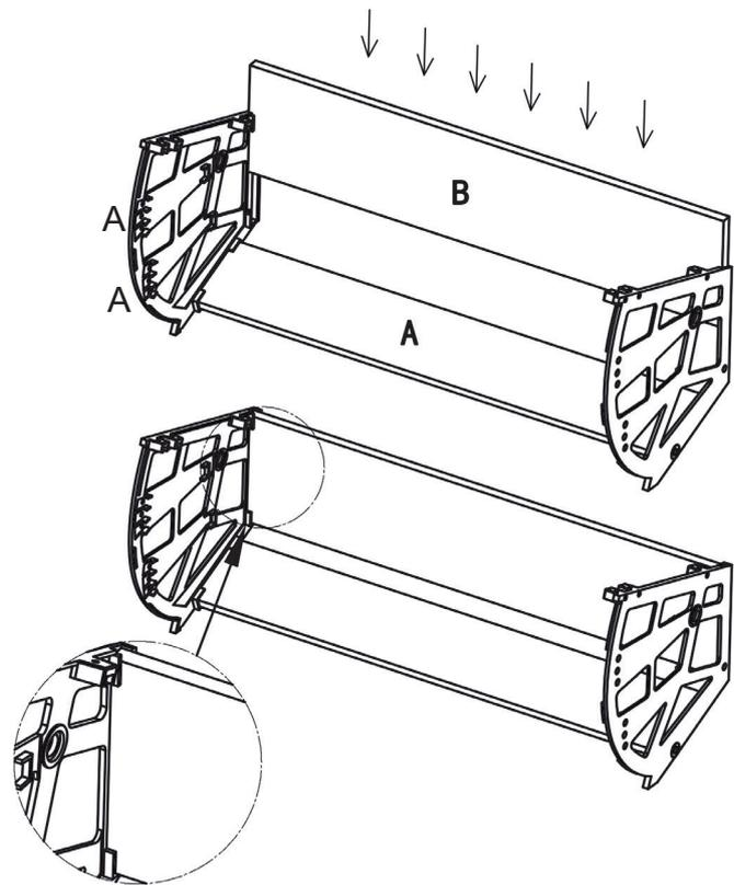
A=Szélesség(korpusz belső szélesség-11 mm)× 94 mm × 12 mm
