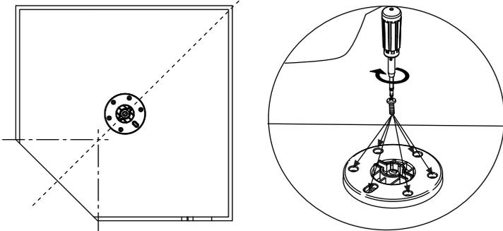
**2** Fissare la piastra superiore (G) al centro del tetto del mobile, in corrispondenza della piastra di base, utilizzando le viti in dotazione.
